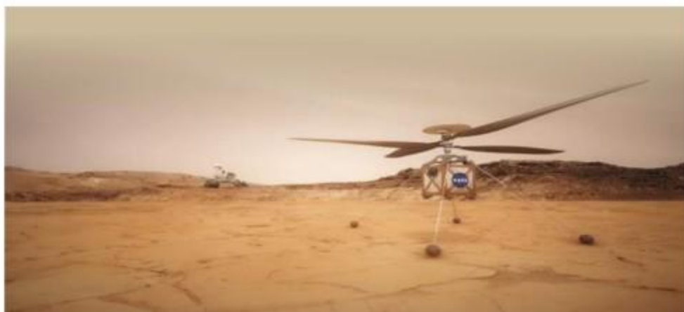
▲ Автономный летательный аппарат Mars Helicopter — небольшой дрон, который NASA собирается доставить на соседнюю планету в рамках миссии Mars 2020 для демонстрации возможностей использования винтокрылых зондов при исследованиях тел с разреженной атмосферой (в Солнечной системе таковым фактически является только Марс).
