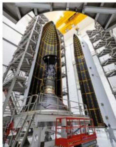
▲ Установка зонда Parker Solar Probe под 19-метровый головной обтекатель производилась в цехах компании Astrotech Space Operations (Титусвилль, Флорида). Позже аппарат был доставлен на стартовый комплекс LC 37 станции ВВС США «Мыс Канаверал».
